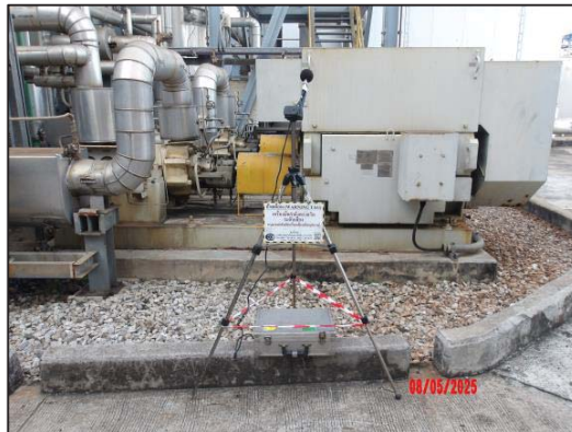
รูปที่ 3.13 การตรวจวัดระดับเสียงในพื้นที่ทำงาน บริเวณ Boiler Feed Pump
