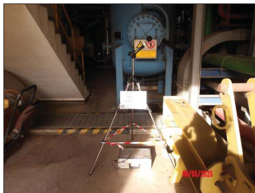
รูปที่ 3.14 การตรวจวัดระดับเสียงในพื้นที่ทำงาน บริเวณ Steam Turbine
