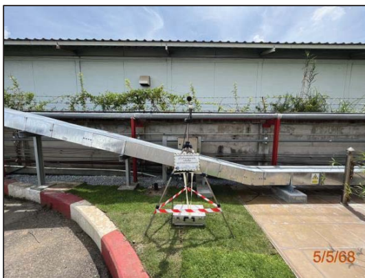
รูปที่ 3.5 การตรวจวัดระดับเสียงโดยทั่วไป บริเวณ ริมรั้วโรงไฟฟ้า
