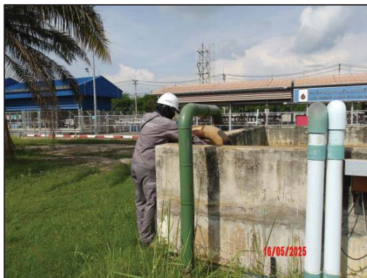
รูปที่ 3.8 การเก็บตัวอย่างคุณภาพน้ำทิ้ง บริเวณ จุดระบายน้ำของโรงไฟฟ้า ก่อนไหลลงรางระบายน้ำทิ้งของนิคมฯ (บ่อบำบัดน้ำเสียของบริษัท บี.กริม เพาเวอร์ (แหลมฉบัง) 1 จำกัด)
