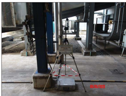
รูปที่ 3.10 การตรวจวัดระดับเสียงในพื้นที่ทำงาน บริเวณ HRSG 3 - East
