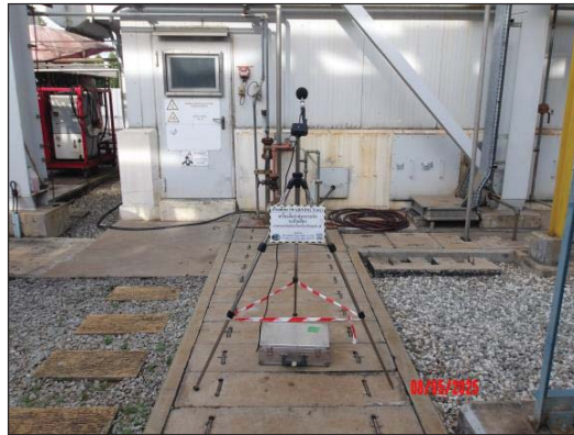
รูปที่ 3.12 การตรวจวัดระดับเสียงในพื้นที่ทำงาน บริเวณ Gas Turbine 3 - South
