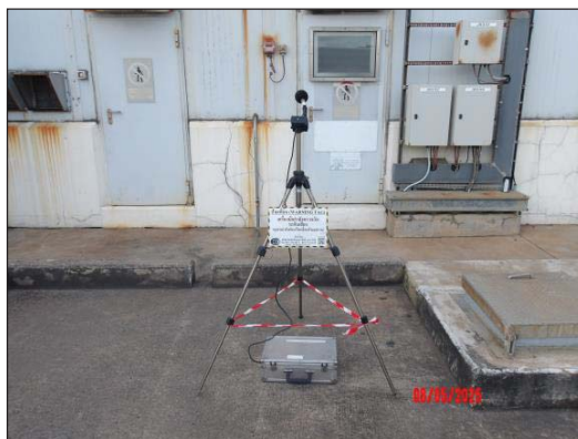
รูปที่ 3.10 การตรวจวัดระดับเสียงในพื้นที่ทำงาน บริเวณ HRSG 3 - East
